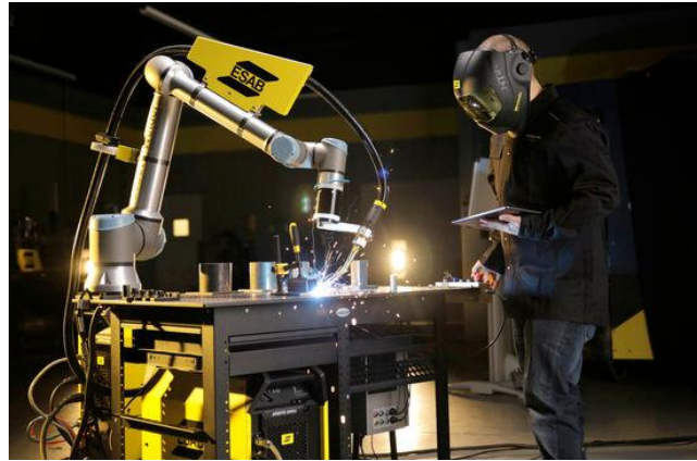
Gambar 10. ESAB Cobot: Membantu Manusia Untuk Melakukan Penyolderan dan Pengelasan. Sumber: https://esab.com/us/nam_en/products-solutions/product/robotics/cobots/cobot-solutions-rtw/esab-cobot/
